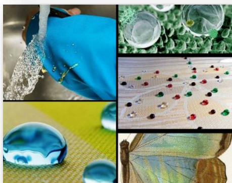
صورة رقم 6 للاقمشة الطاردة للماء وذات خاصية التنظيف الذاتي (مرجع 26)
